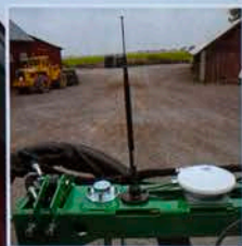
Maskinen har GPS med RTK-noggrannhet (cirka 2,5 cm).
