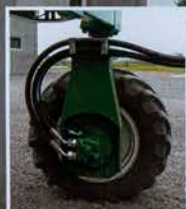
Hydrauldrivning på alla fyra hjulen.
